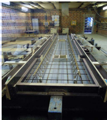
Obr. 16 - Příklad použití desek pro částečnou prefabrikaci „filigrán“
